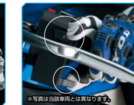
Suzuki Drive Mode Selector (S-DMS) ※写真は当該車両とは異なります。
